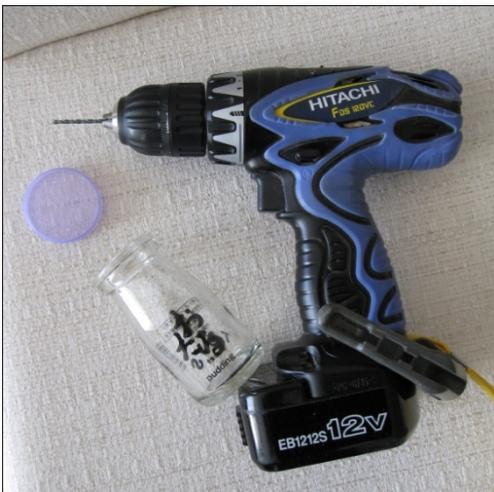
このプリンにはキャップがあるんだ。左の写真で写る青くて丸いのがそれね。このキャップにドリルを使って穴を開けます。一般的に売られている塩瓶には2.5mmの穴が開いていたからこれと同じサイズのドリル刃を用いて穴をあけるわけです (・ ー ・) b ちなみに一般に広く売られている塩瓶で似たようなサイズの物をチェックしてみると、そのキャップには5つの穴が開けてあったから穴数もこれに習うようにしてみたぞ。ドリルを使うときは手を怪我しないように気をつけて作業してちょ そんでもって
